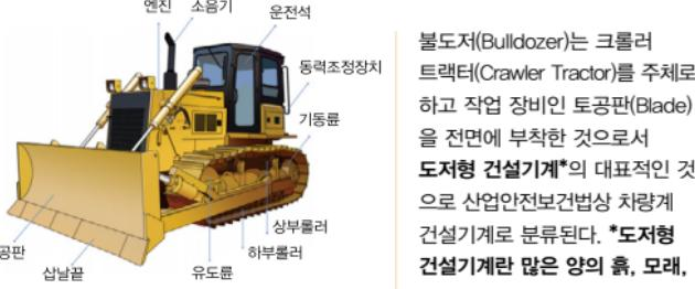
불도저(Bulldozer)는 크롤러 트랙터(Crawler Tractor)를 주체로 하고 작업 장비인 토공판(Blade)을 전면에 부착한 것으로서 **도저형 건설기계**\*의 대표적인 것으로 산업안전보건법상 차량계 건설기계로 분류된다. \*도저형 건설기계란 많은 양의 흙, 모래, 자갈 등을 밀어내어 지면을 고르거나 굽착하기 위한 기계를 말한다. 엔진은 디젤 기관으로 크롤러식 주행 장치와 몸체, 엔진, 클러치, 변속기, 감속장치 등이 있다. 100m 이내의 단거리 작업에 적합하며 송토, 굴토, 쟁토 및 확토 작업을 한다.
